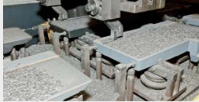
Fresatura superficiale dei piani in ghisa
