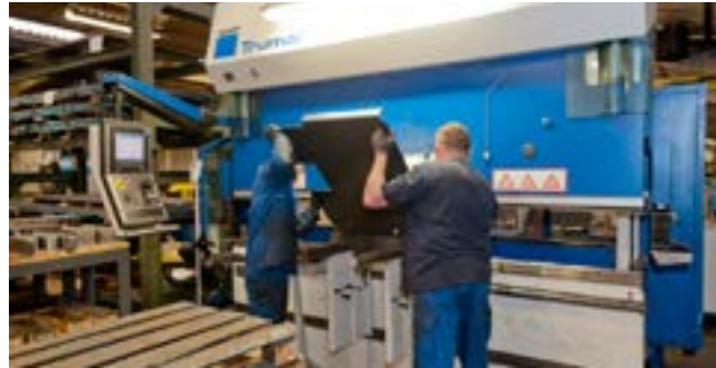
Piegatura dei carter in lamiera assistito da computer
